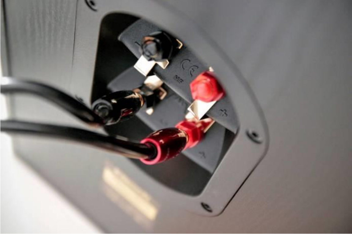
Klipsch RB-81 MKII'nin terminalleri çift amplifikasyona olanak tanır. Burada, Audioquest Rocket 88 kablolarına bağlanırlar.
