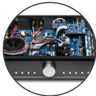
Dikkatli Ayarlanmış Düşük Gürültülü, Yüksek Kazançlı MM Phono Kademesi
