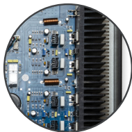
Tamamen Ayrık Transistör Class A/B Amplifikatör
